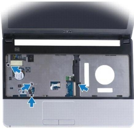
8. Heben Sie die Verbindungsglasche an und heben Sie die Zuglasche an, um das Touchpadkabel vom Systemplatinenanschluss zu trennen.
